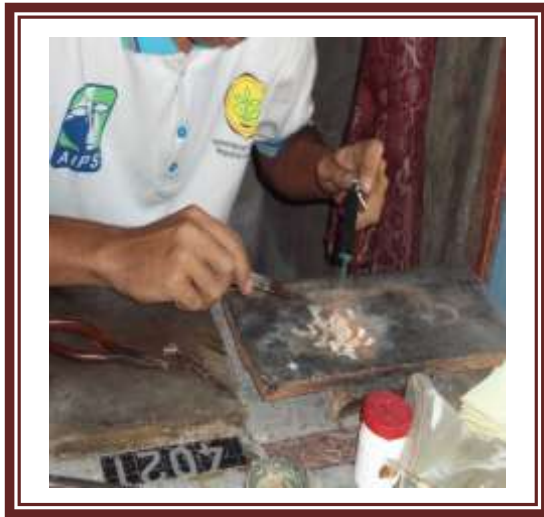
Gambar 2. Pengelasan Logam Tembaga Dengan Las Tiup.
