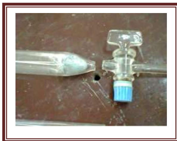
Gambar 7. Tabung Buret yang perlu diperbaiki dengan las kaca
