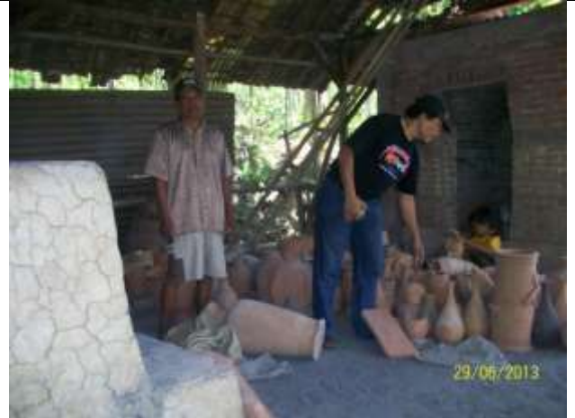
Usai pembakaran. perlu pemeriksaan bang yang pecah atau retak.
